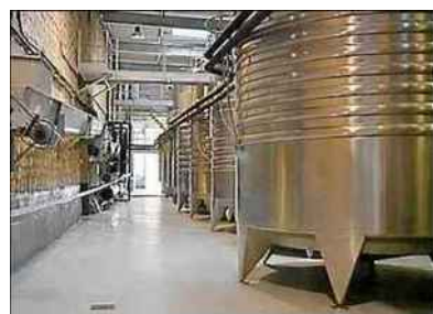
■ Chaque cuve de blanc est équipée d'une ceinture réfrigérée.
